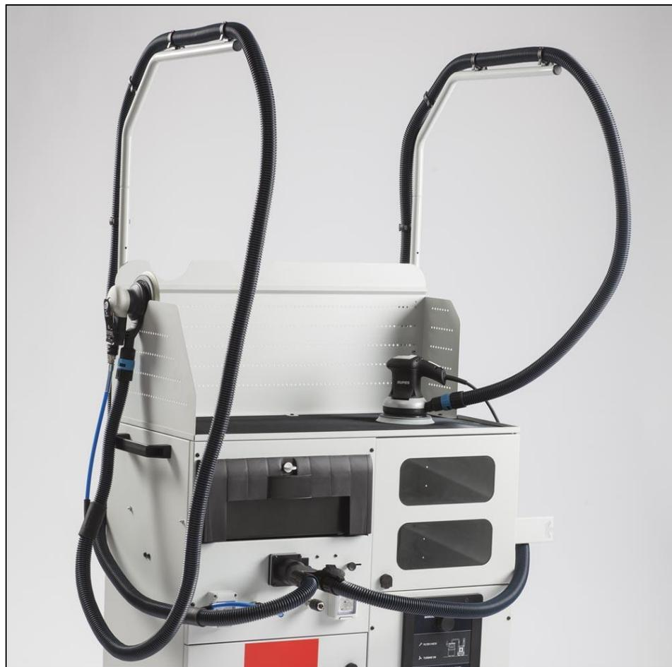
Гибкий шланг может быть установлен на консоли для поддержки одновременной работы двух пользователей. Консоль (1 шт. включена) поддерживает вес шланга и предотвращает его нахождение на полу. Дополнительная консоль может быть установлена для поддержки двух пользователей одновременно.
