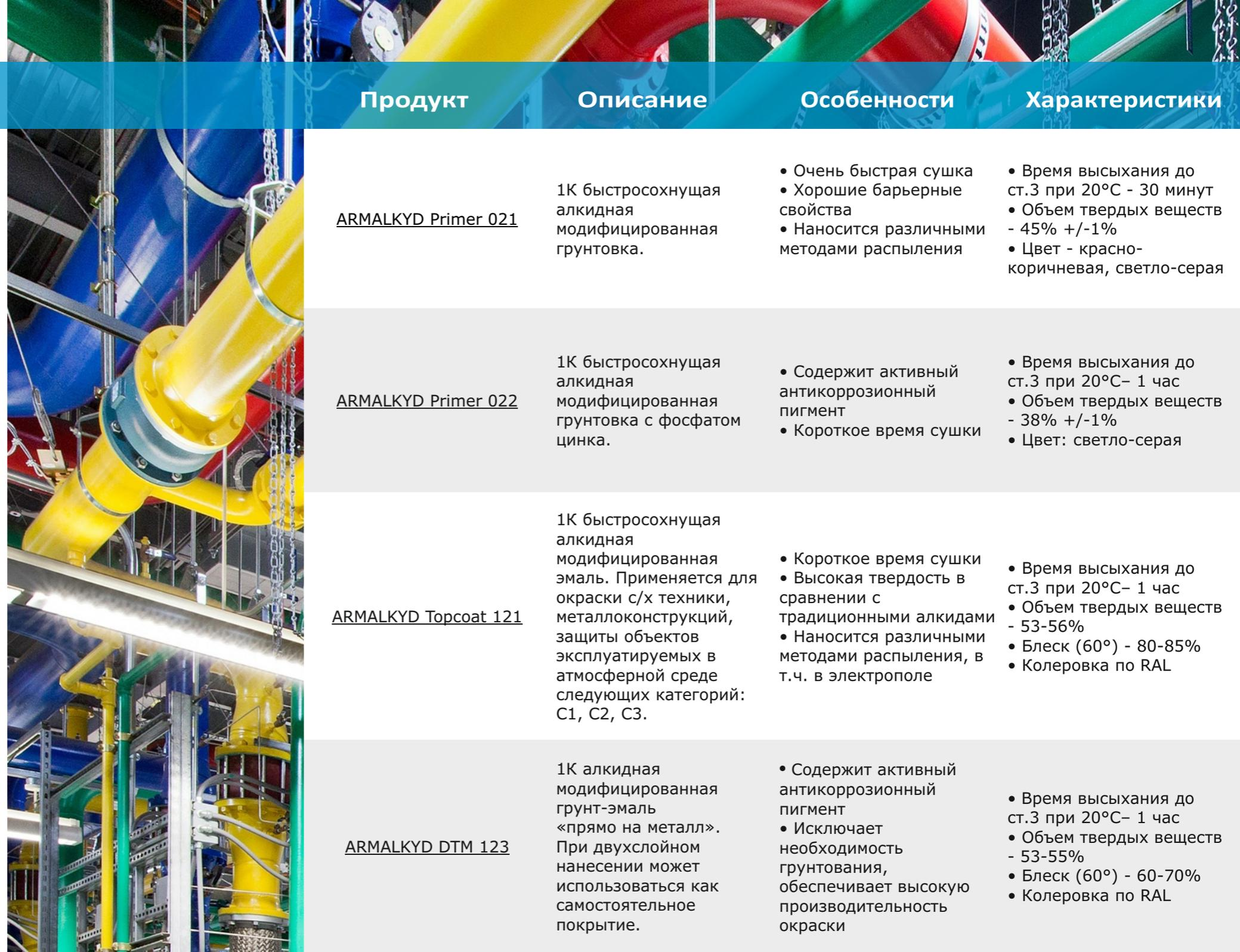
ARMALKYD® - однокомпонентные алкидные модифицированные быстросохнущие грунтовки, эмали и грунт-эмали DTM (Direct to metal) для окраски изделий из черных металлов.
